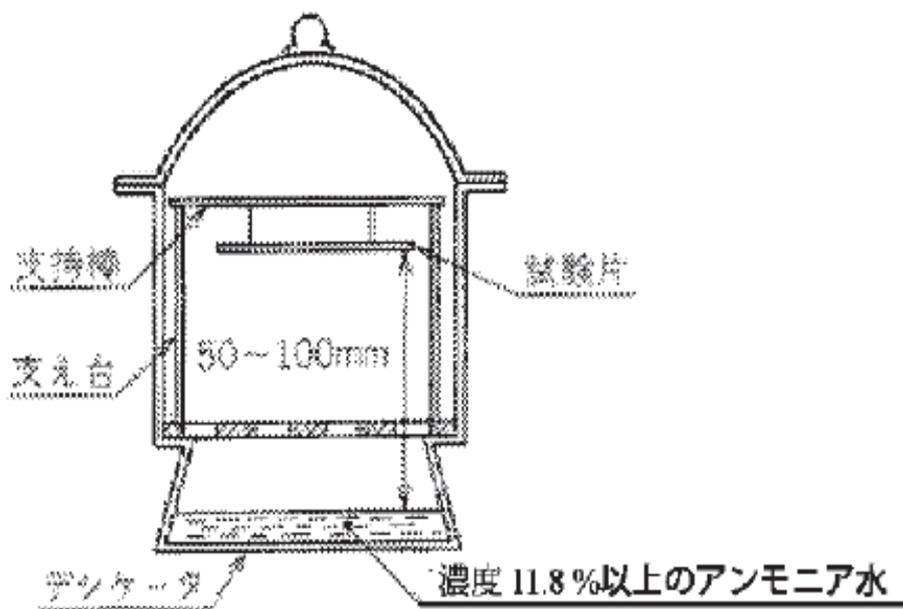
参考图 1 水氨溶液试验法
